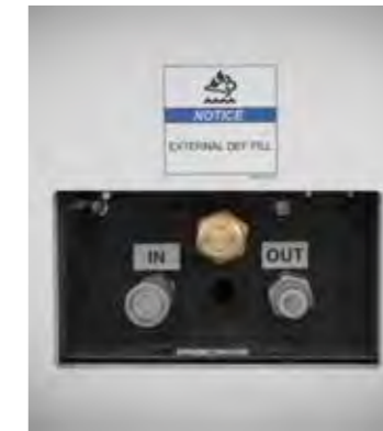
Uzaktan yakıt deposu bağlantısı
